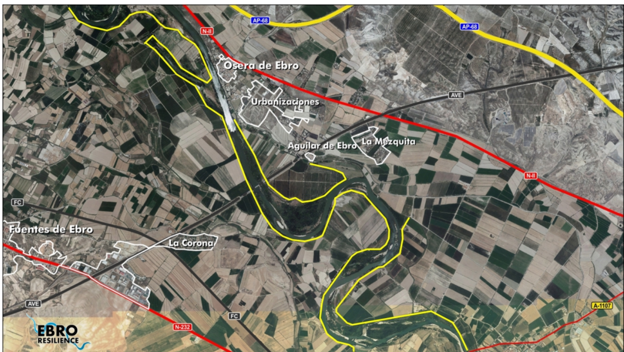
Figura 2. Tramo de estudio. Señalados en amarillo los diques longitudinales que delimitan la canalización (elaboración propia).
