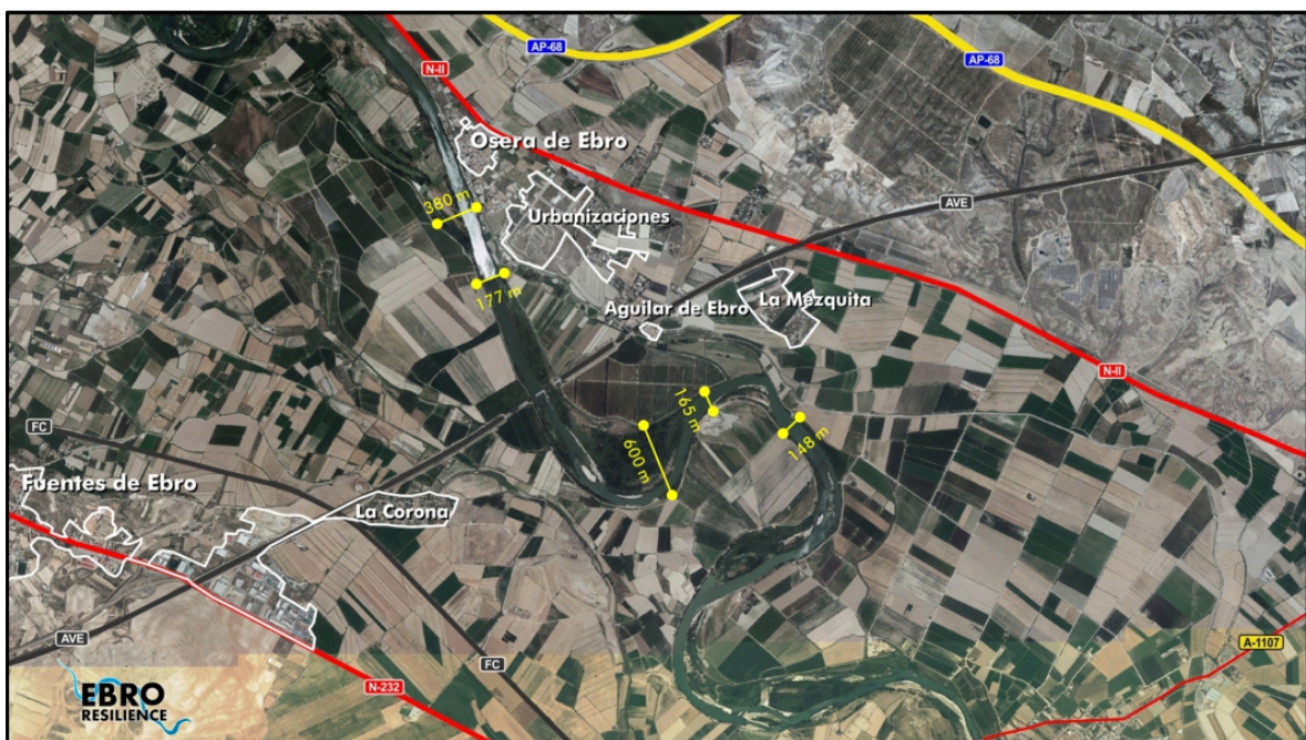
Figura 3. Estrechamientos existentes en la actual canalización (elaboración propia).
