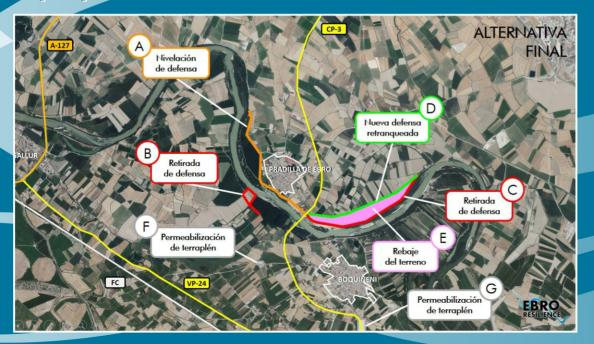
El río Ebro a su paso entre las localidades de **Pradilla de Ebro** y **Boquiñeni** se encuentra con un importante estrechamiento en la canalización que reduce la anchura efectiva de la misma a 166 metros.
